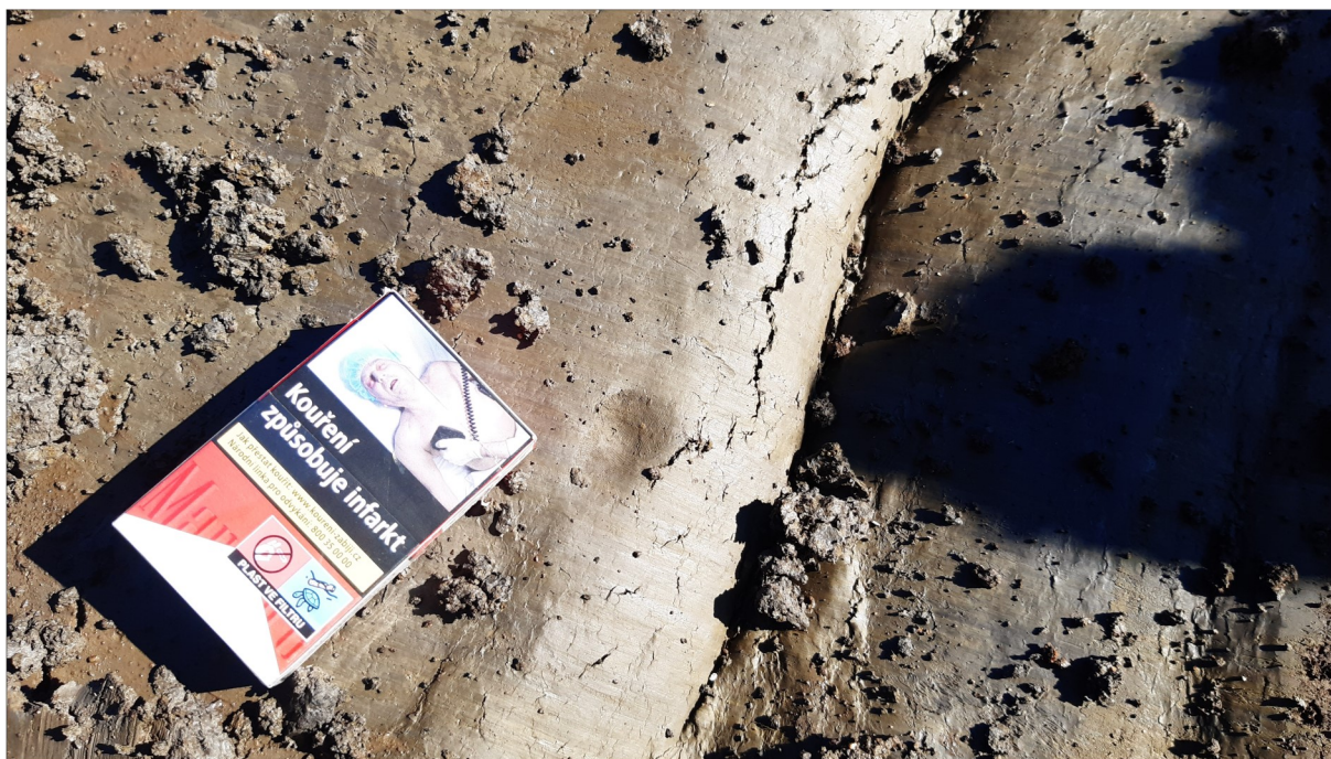
Obr. 8 Prachovitý jíl pevné konzistence.
