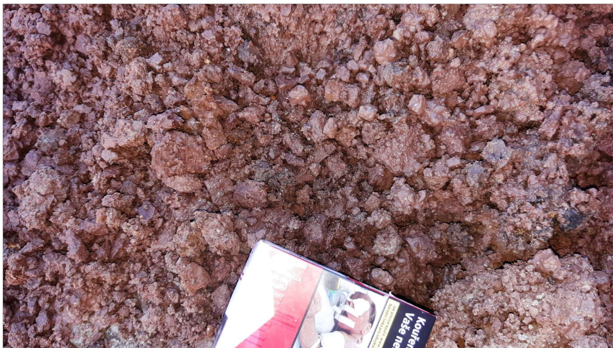
Obr. 9 Silně zvětralý prachovec.
